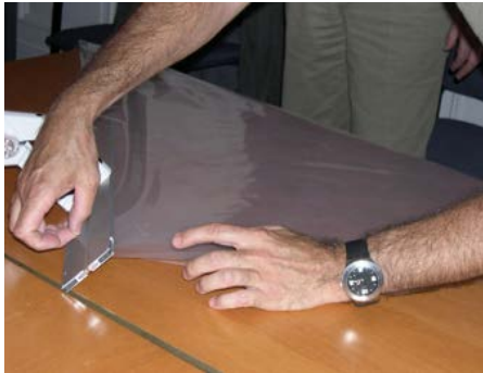
Foto 4 en 5. Dichtlassen van de anoxiezak aan drie zijden.
