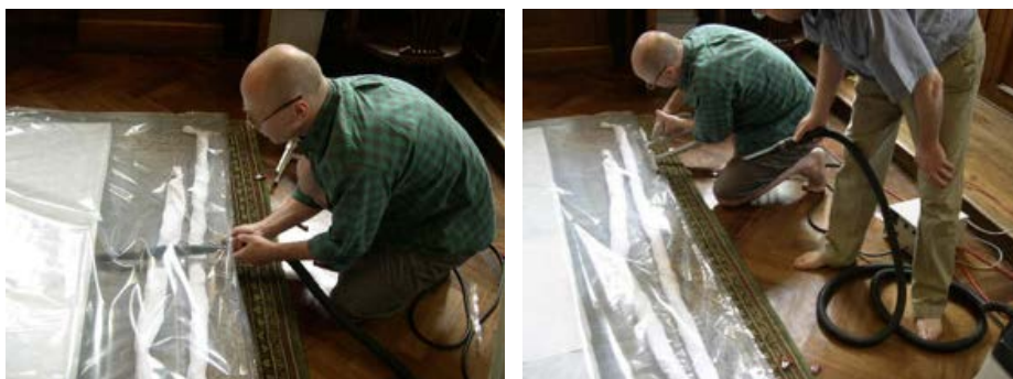
Foto 12. Wegzuigen van overtollige lucht met behulp van een stofzuiger. Het volume van de zak verkleint. U zal zien dat de zak strakker rondom het voorwerp trekt. Daarna moet u snel het laatste stukje van de zak dichtlassen.
