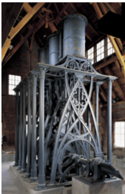
Blowing engine „Schwarzenberg Gebläse“, Freiberg (built 1830)
